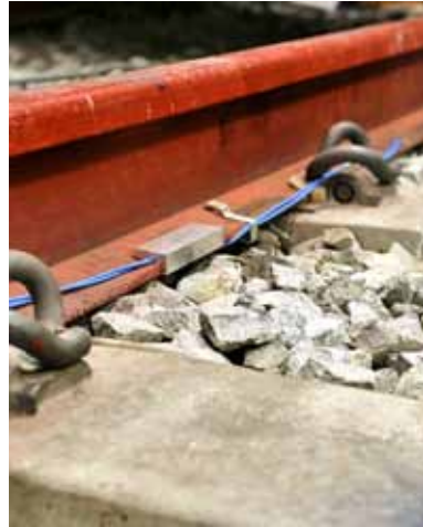
Laserový senzor pro kontrolu zatížení na patě kolejnice
