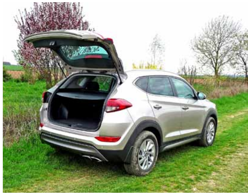
Hrana výklopného zadního víka sahá do výšky 185 cm, zavazadelník s plnohodnotnou rezervou má objem 488 l
