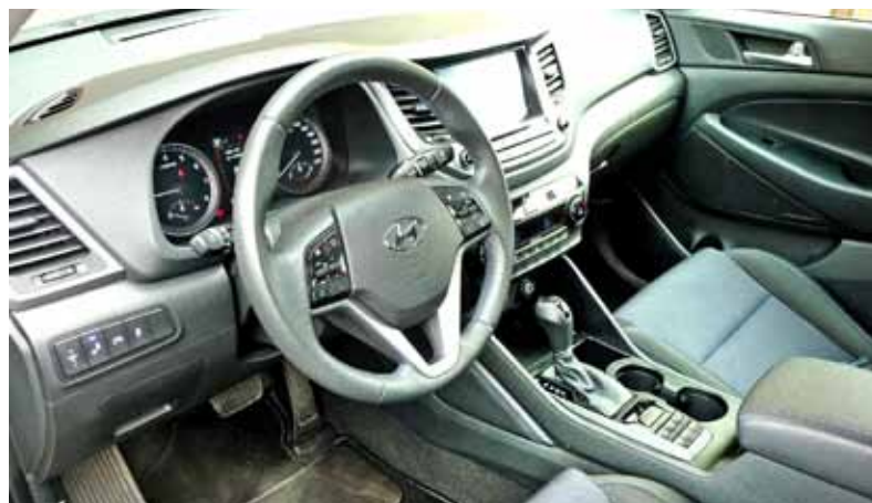
Pracoviště řidiče plní představy o moderním automobilu, kromě páky voliče převodovky DCT se na středním panelu ovládají funkce spojené s pohonem 4WD
