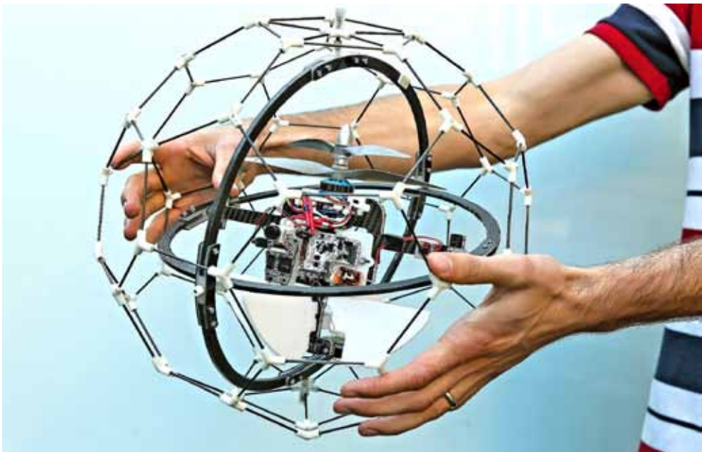
Dron GimBall je spirálová konstrukce připravena létat do úzkých a nebezpečných prostor. Švýcarský konstrukční tým za něj získal vítězství v prestižní mezinárodní soutěži Drones for good Award. Představil se i účastníkům letošní konference TED v Edinburgu (TED - Technology, Entertainment, Design)
