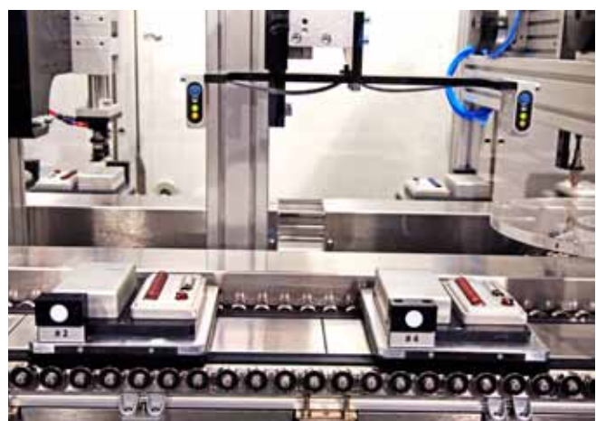
Dopravníkový systém MCS v kombinaci s pásovým dopravníkem od Elcomu v duchu filozofie Průmyslu 4.0
