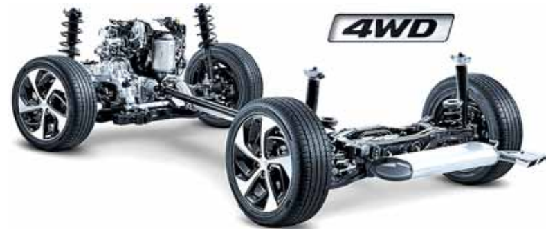
Podvozková partie a hnací soustava pohonu všech kol s elektromagneticky ovládanou spojkou zadního diferenciálu
