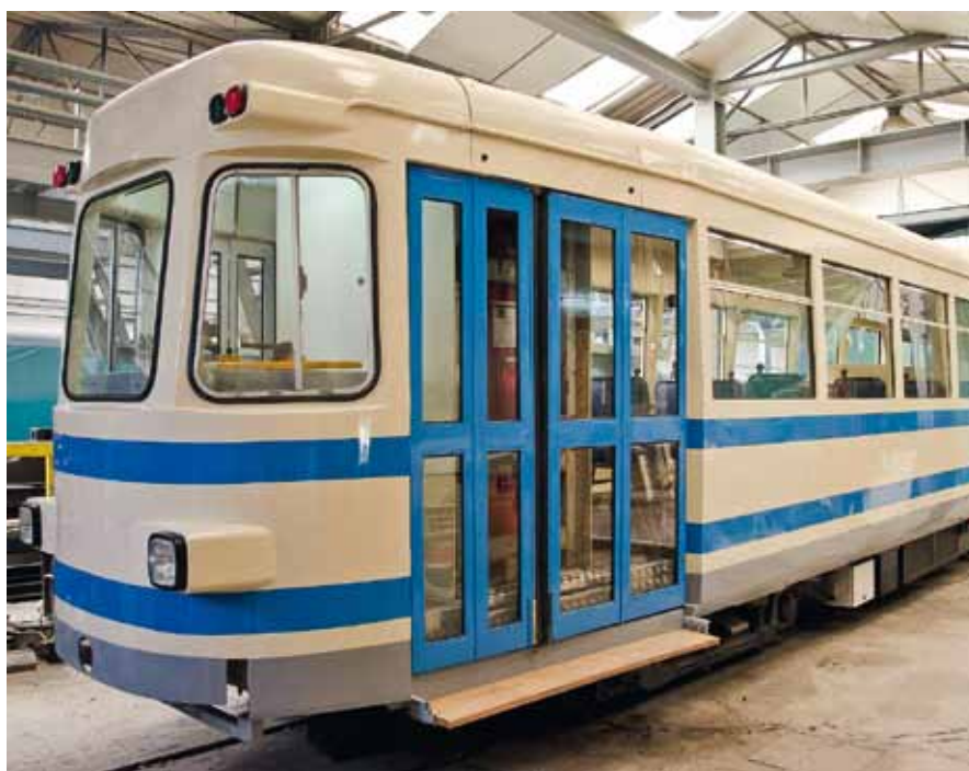
Nedokončený vývoj španělské vodíkové tramvaje FEVE pro Valencii s výkonem 120 kW z roku 2012
