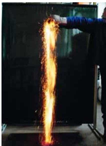
Nanočástice \text{Fe(O)} při styku se vzdušným kyslíkem – demonstrace mimořádné reaktivity nanočástic elementárního železa
