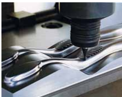
Obr. 2: Vysokorychlostní obrábění na obráběcím centru Haas
