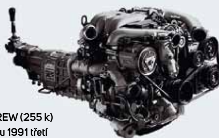
↑ Rotační motor Mazda 13B Turbo z roku 2007
