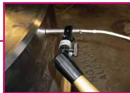
Obr. 2: Uspořádání měřidel při bezkontaktním měření výchylky na obrobku
