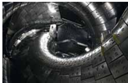
Pohled do nitra dlouho největšího stelarátoru na světě, japonského LHD, poskytuje představu o geometrii těchto zařízení.
