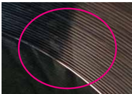
Obr. 1: Soustružení vnitřní plochy, vlny na povrchu
