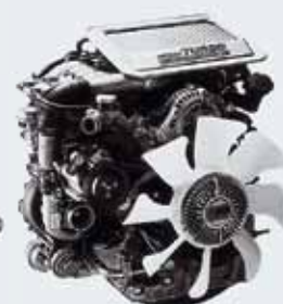
↑ Rotační motor Mazda 13B Turbo z roku 2007
