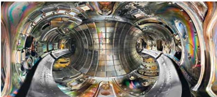
Pro srovnání pohled do komory tokamaku (německého TEXTORu), který sice funguje na podobném principu, ale jeho komora má zcela pravidelný tvar. Na snímku je její pravidelnost samozřejmě narušena použitým objektivem.
