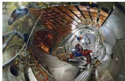
Pohled do budoucí plazmové komory stelarátoru W7-X ilustruje nepravidelný tvar daný simulací požadovaného tvaru magnetického pole a dává i trochu tušit technické obtíže spojené se zprovozněním podobného zařízení.
