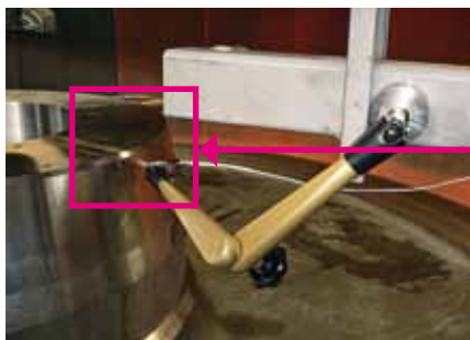
Obr. 2: Uspořádání měřidel při bezkontaktním měření výchylky na obrobku
