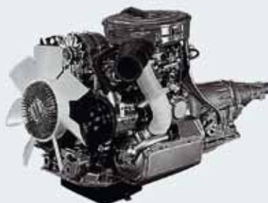
↓ Rotační motor 13B byl vyráběn od roku 1975.
