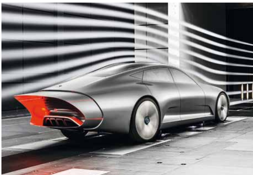
Zadní část vozu se v rychlostech nad 80 km/h automaticky vysouvá až o 390 milimetrů.
