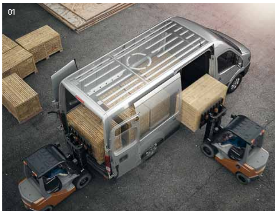
01 > Nákladový prostor (10,5 m 3 u verze dlouhé 5,5 m) pojme také pět standardizovaných europalet (1200 mm x 800 mm x 900 mm) a uživatelé je mohou snadno nakládat a vykládat díky nadprůměrné výšce a šířce nákladového prostoru
