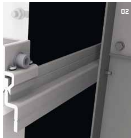
02 > Zavěšení fotovoltaických panelů na systém Hafix
