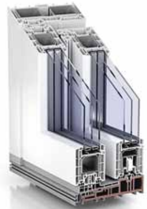
03 > Standardem je osazení trojskly, takže prostup tepla se běžně pohybuje od U_w = 0,9 - 0,78 \text{ W/m}^2\text{K}
