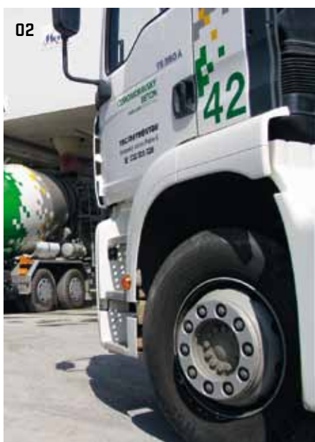
02 > Nejčastěji se používají autodomíchávače s objemem bubnu 5 až 9 m 3
