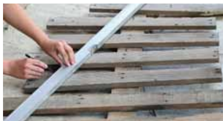
3 Ze středu vrchní latky po okraj poslední narýsujte čáry tak, aby vytvořily trojúhelník
