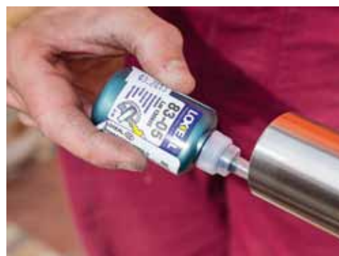
12 Madlo jsem opatřil záslepkou, kterou jsem upevnil pomocí speciálního lepidla na nerez
