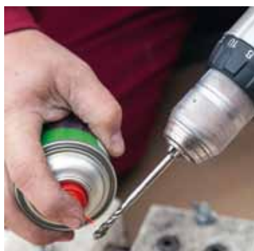
11 Vrtání do nerezového madla usnadní řezný a vrtací olej ve spreji
