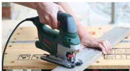
4 Podle této rysky pak postupně odřežte okraje jednotlivých latí a hned je ukládejte na své místo
