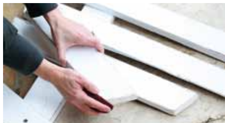
7 Hrany zlehka ohladte smirkovým papírem, čímž vytvoříte efekt patiny
