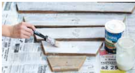
6 Latky natřete bílou barvou, zředěnou s vodou v poměru 1 : 1. Následně naneste 2–3 vrstvy neředěné barvy
