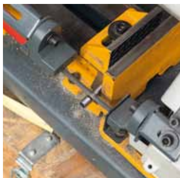
14 Na krácení tyčoviny jsem použil elektrickou pilku s plátkem na nerez
