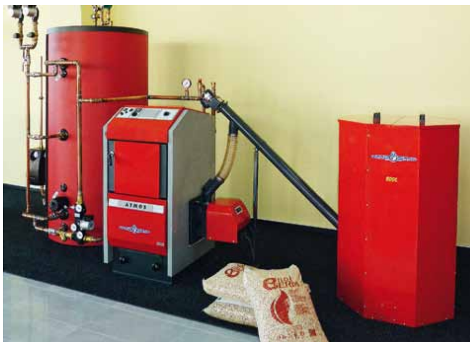
Ekologický a plne automatický kotol na pelety ATMOS D31P je konštruovaný na dokonalé spaľovanie peliet. Horák na pelety môže byť zabudovaný do ľavej či pravej strany kotla. Automaticky si pomocou šnekového dopravníka odoberá pelety zo zásobníka. (ATMOS)
