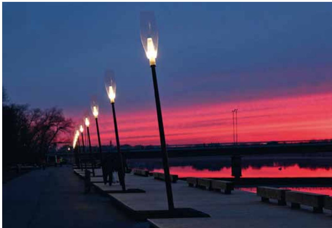
Obr. 9: „Pádlová lampa“ (Paddle lamp), Pärnu, Estonsko, design Margus Triibmann, KEHA3, ve spolupráci s Luhse & Tuhal architects, materiál PMMA a ocel, světelný prvek 35W HIT
