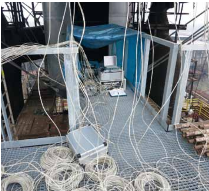
Obr. 6: Měření sil v táhlech při předpinání
