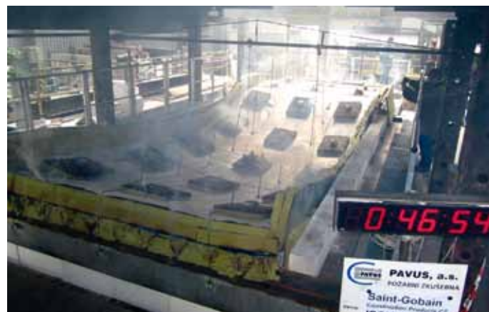
Lehké požárně odolné střechy PROTECT ROOF® prošly náročnými požárními zkouškami na zkušebně PAVUS a plně rozvinutému požáru uvnitř budovy odolávají více než 45 minut
