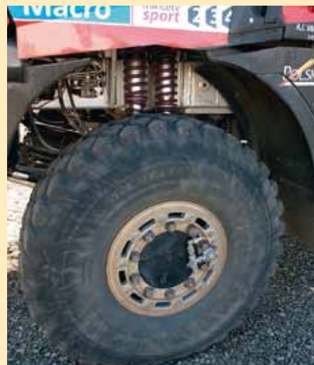
Samozřejmostí je u soutěžního speciálu upravené pérování a tlumiče, ale také možnost dohušťovat pneumatiky za jízdy
