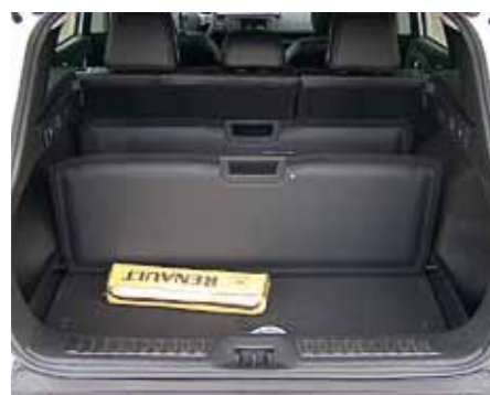
Podlaha kufru je dělená, výjimatelná a lze s ní zavazadlový prostor i rozdělit na menší oddělení
