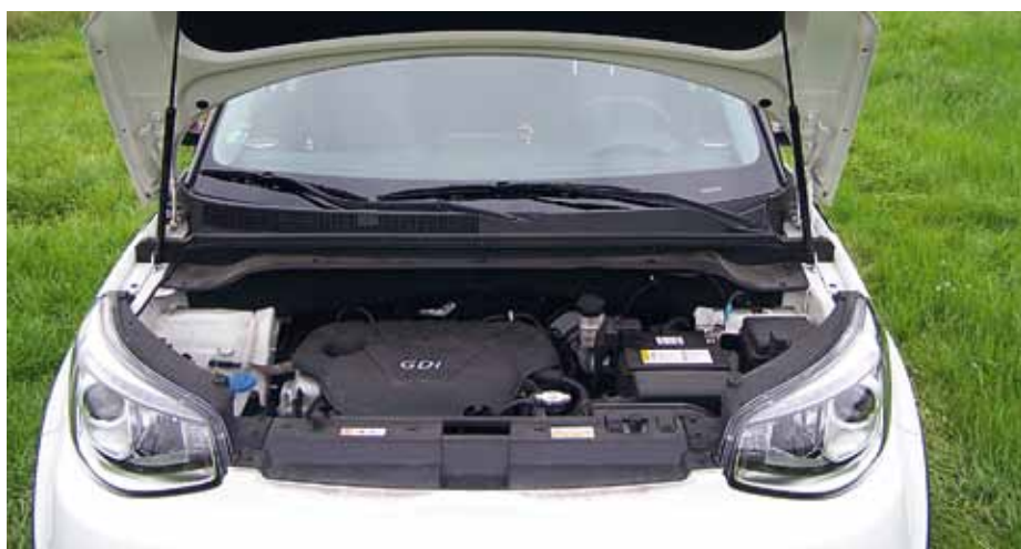
Zážehový motor 1.6 GDI se musí vce „točit“ a pak je poněkud „hladový“
