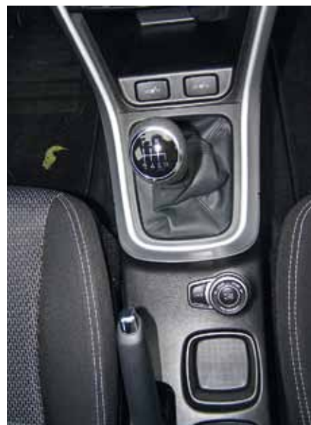
Před řadící pákou jsou spínače vyhřívání sedadel, za ní pak volič jízdních režimů pohonu 4x4
