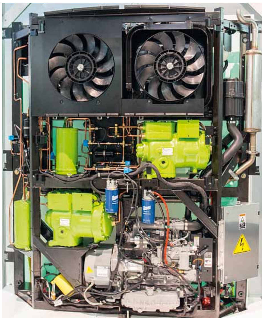
Prototyp transportní chladicí jednotky s přírodním chladicím médiem R744
