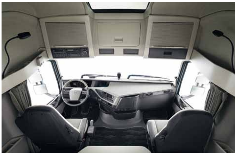
Interiér je prostorný, volič jízdního režimu automatizované převodovky I-Shift je umístěn vpravo vedle sedadla
