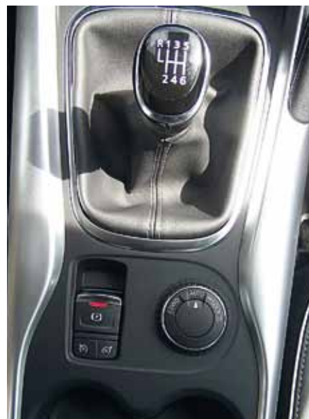
Za řadicí pákou je otočný volič pohonu kol a u elektrické parkovací brzdy spínač tempomatu resp. omezovače rychlosti
