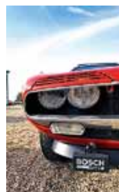
Mřížky nad kulatými světlomety se při jízdě automaticky odsouvají
