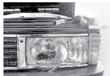
Světlomet Bosch s integrovanou mlhovkou, stěračem a ostřikovačem
