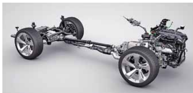
Nový motor je před přední nápravou kvůli těžišti uložen co nejnižší
