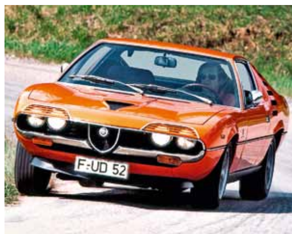
Základem je upravená platforma série 105. Osmiválec se pod kapotu skoro nevešel
