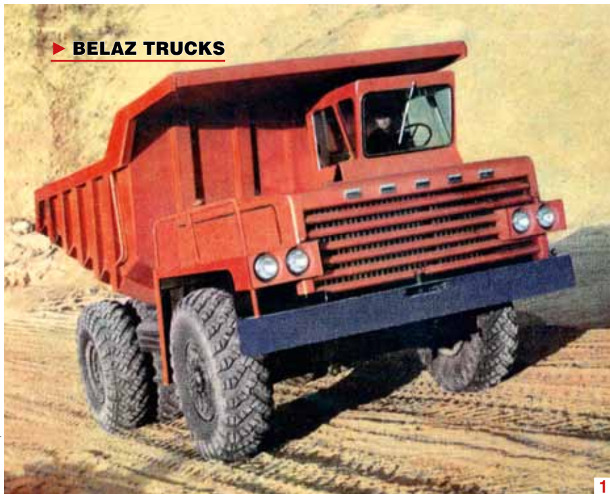
Tahač BělAZ 540V se sklápěčkovým návěsem (užitečná hmotnost 40 tun)
